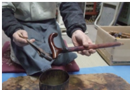
5: 色付け・塗装・・・染料が木材の導管に沈着するまで何度も行なう。この時間のかかるこだわりの作業が、柰目を生かした美しい深みのある色合いを作り上げる。色付け後、表面をウレタン樹脂で塗装仕上げ。
