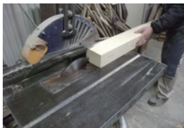
2: 製材・・・杖手元や支柱に合わせた形状に製材。木材の種類によって様々な柰目（もくめ）があり、この柰目の取り方も職人の技術の一つ。柰目の取り方でステッキとしての十分な強度を確保することにもなる。
