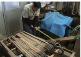
3: ため（微調整）・・・角材で仕入れしている材料は自然乾燥後、小さな反りをステッキ職人の感覚でまっすぐに修正。
