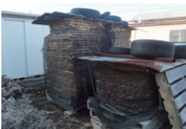
1: 素材・・・熟練したステッキ職人の目で厳選した材料を最低1年以上かけて自然乾燥。機械乾燥させた材料や湿気が十分に取りきれいな材料は、ステッキの変形の原因となるため、じっくりと自然乾燥させる。
