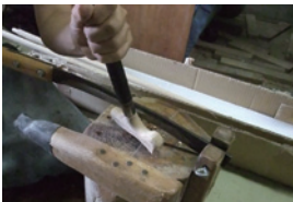
4: ルーター（削り作業）・・・杖手元は、ステッキそれぞれに合わせた形に大まかにカット（杖手元作成／引抜）。材料を、何種類もの専用の刃物を用いて形を整え、最終的な杖手元の形に削りながら仕上げていく。
