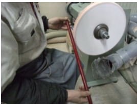
4: ルーター（削り作業）・・・杖手元は、ステッキそれぞれに合わせた形に大まかにカット（杖手元作成／引抜）。材料を、何種類もの専用の刃物を用いて形を整え、最終的な杖手元の形に削りながら仕上げていく。
